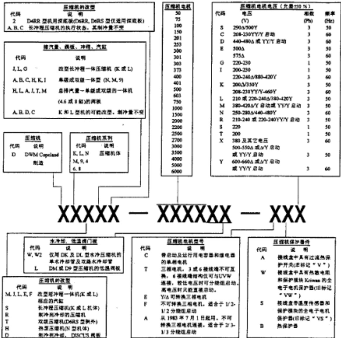
图 4 德国谷轮半封闭压缩机的型号含义 (连体型压缩机见其单机铭牌)
