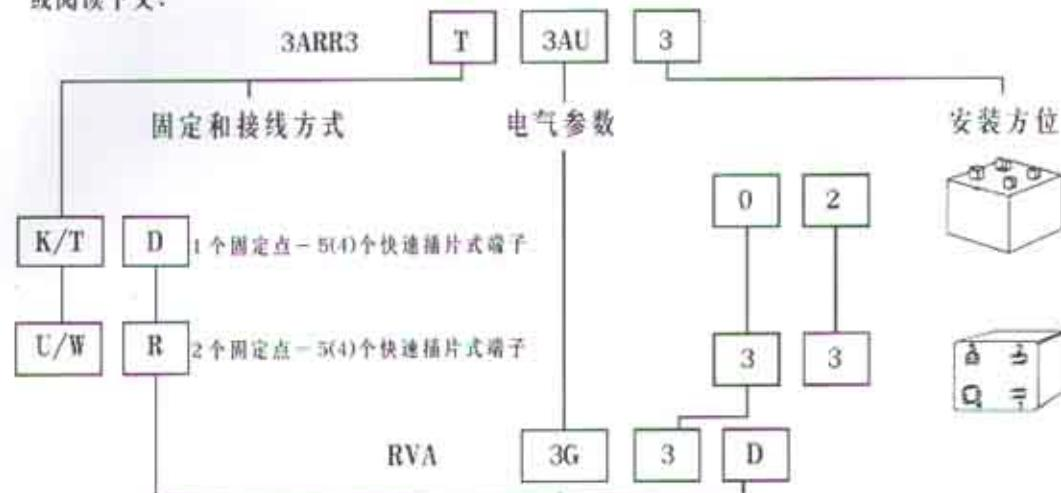
注：必须按照规定的安装方位安装继电器，这由继电器型号中的最后一位数字给出。
